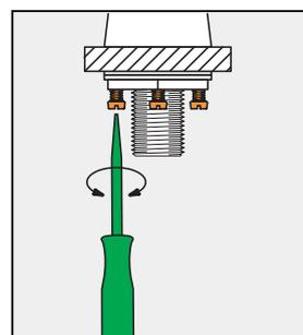
Fixation renforcée par 3 vis inox (anti-torsion)
